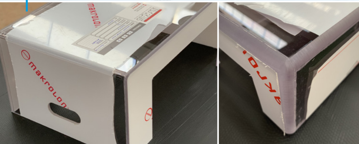
TAGLIO A FRESA + INCOLLAGGIO MILLING + CUTTING OFF
