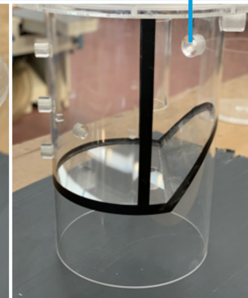
TERMOFORMATURA + LAVORAZIONE 5 ASSI + INCOLLAGGIO THERMOFORMING + 5-AXIS MACHINING + BONDING
