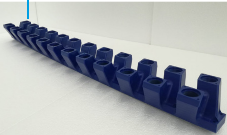
SEZIONATURA + LAVORAZIONE 5 ASSI PIÙ COMPLESSA CUTTING OFF + COMPLEX 5-AXIS MACHINING
